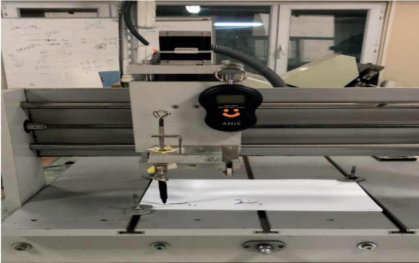
Şekil 4. CNC cihazının imzayı kağıda transferi
