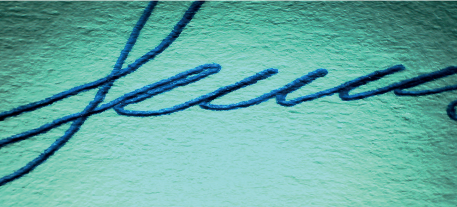
Şekil 10. CNC cihazı ile oluşturulmuş imzaya ait mikroskop görüntüsü
